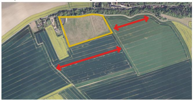
Pour répondre à une insertion maximale du projet dans son paysage, l'idéal serait de réorienter les panneaux dans le même sens que les sillons des terrains mitoyens. (Environ 17 ° et donc une perte minimale dans la production énergétique)
